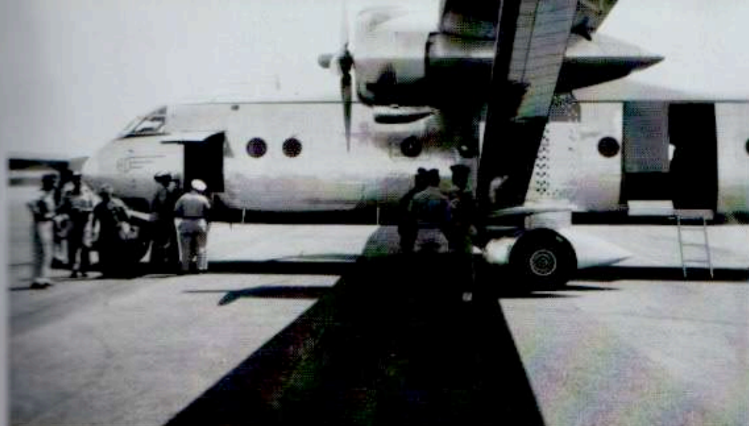
Monoplan haubané de grand allongement Hurel-Dubois HD-321 de l'escadrille de liaisons aériennes 1/56 « Vaucluse » du SDECE. Basé à Akrotiri, cet appareil est destiné à des missions clandestines menées en liaison avec le 11 e Choc ainsi qu'à des prises de vues photographiques. (Coll. Salbert)
